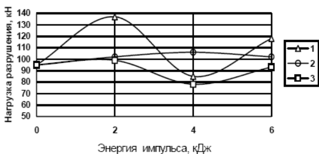
Рис. 6 Изменение усилия разрушения в зависимости от энергии импульса: 1—2 импульса, 2—4 импульса,
